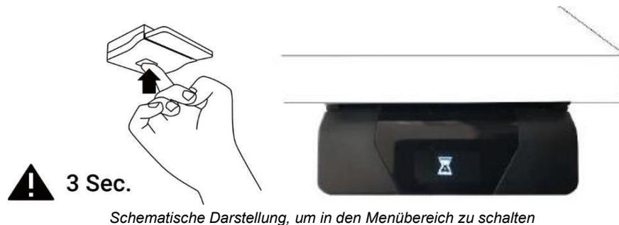
Im Menüpunkt „Offset“ kannst du die Anzeige der Tischhöhe anpassen, ohne dass der Tisch bewegt wird. – z.B. um die Tischplattendicke zu berücksichtigen. Der Wert der Starthöhe bezieht sich auf die mechanische Starthöhe der Säule. Der werkseingestellte Wert beträgt 65. Mit Hilfe des Schalters zum Auf/Ab – Bewegen kannst du die Höhenanzeige im Display ändern.
