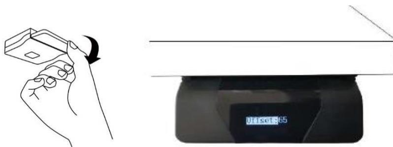
Nachdem du den gewünschten Wert eingestellt hast, halte die Funktionstaste drei Sekunden, um diesen Wert zu speichern. Wenn das Bedienelement länger als 10 Sekunden nicht benutzt wird, schließt sich das Menü und du gelangst wieder zur Höhenanzeige zurück.
