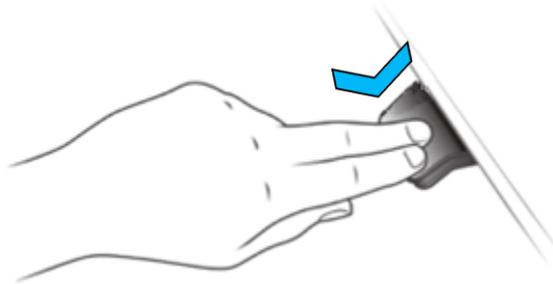
Das System verfährt so lange, bis die Taste losgelassen oder die Endposition erreicht wird.
