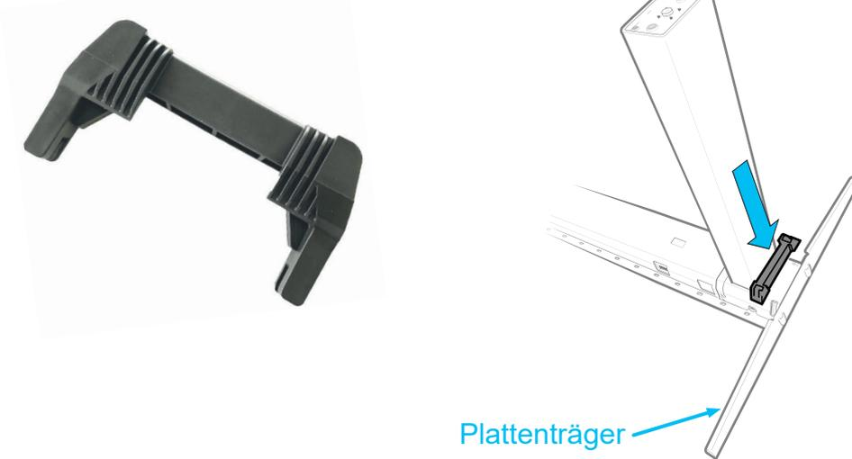
7. Drücke gerade nach unten, um den Plattenträger zu lösen und die Klaue von der Säule zu entriegeln.
