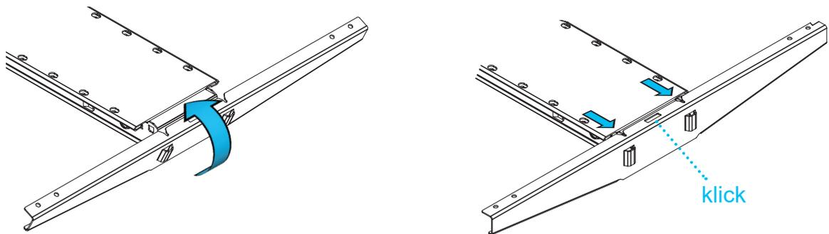
Platziere den Träger so auf der Tischplatte, dass die Anschlüsse für das Bedienelement in Richtung der Bohrungen für das Bedienelement zeigen.
